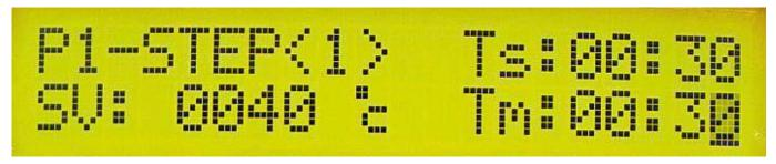
P1-Step — Программа 1 шаг 1, SV — заданное значение, Tm — время таймера, Ts — время, за которое произойдет нагрев до заданной температуры.
