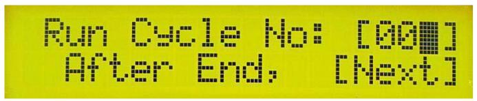
Вы можете установить от 1 до 999 циклов. Если вы хотите, чтобы программа повторялась до отмены нажатием кнопки Старт\Стоп (13), установите значение циклов на 000.
