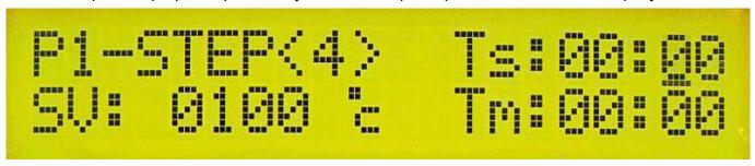
После установки параметров Ts и Tm на 00:00 нажмите на кнопку Установка параметров (12). На дисплее появится следующее сообщение, в котором вы сможете установить количество циклов и задать команды, выполняемые после окончания программы.
